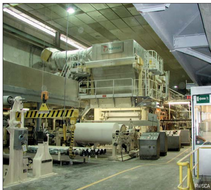
L'usine SCA à Stembert fabrique du papier de base qui est ensuite traité dans deux unités. En photo : la machine à papier nr°1, un modèle Beloit single wire.
