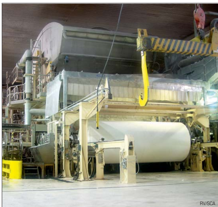
La seconde machine à papier produit du papier hygiénique.
