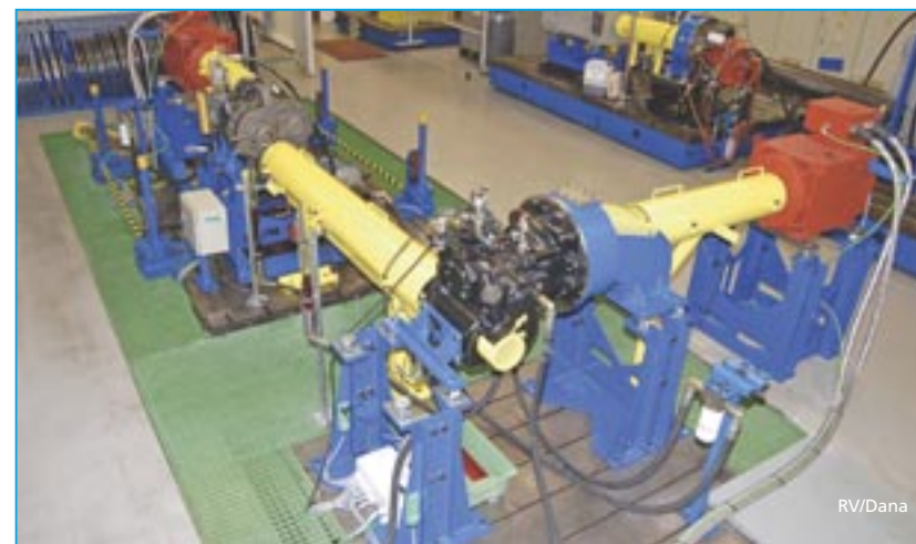
Via de testen wil men zeker zijn dat de schakelkast voldoet aan alle duurzaamheidsvereisten waaraan deze in haar latere levensloop zal onderworpen zijn (hier de Hertz-testopstelling).
