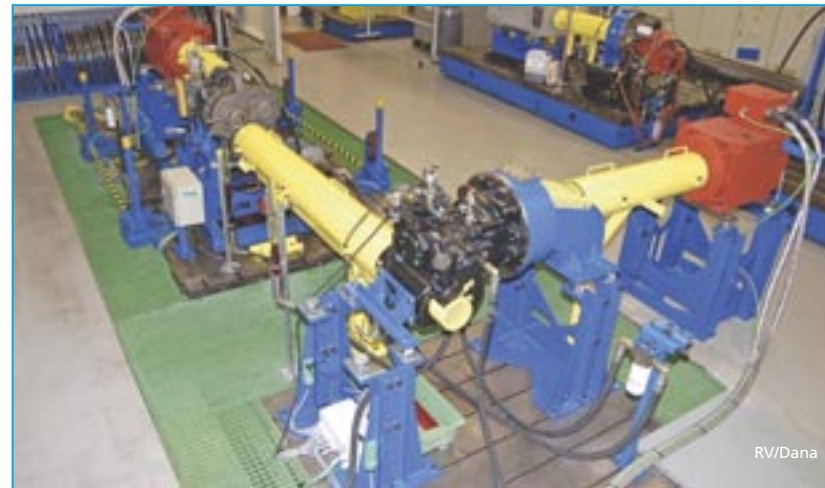
Les tests commencent par la mise à l'épreuve de chaque composant de la transmission, puis c'est la transmission complète qui est testée. En photo : équipement pour la réalisation d'un essai Hertz.
