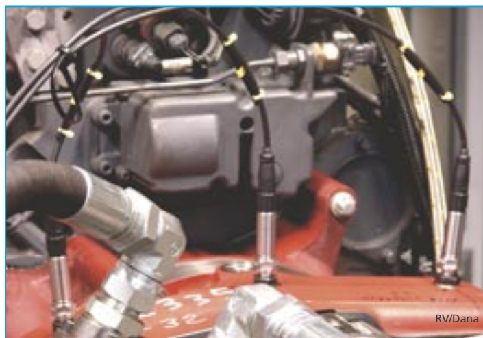
Spicer Off-Highway Drivetrain Products de Bruges utilise l'équipement de mesure de SPM pour la surveillance des essais de transmission.
